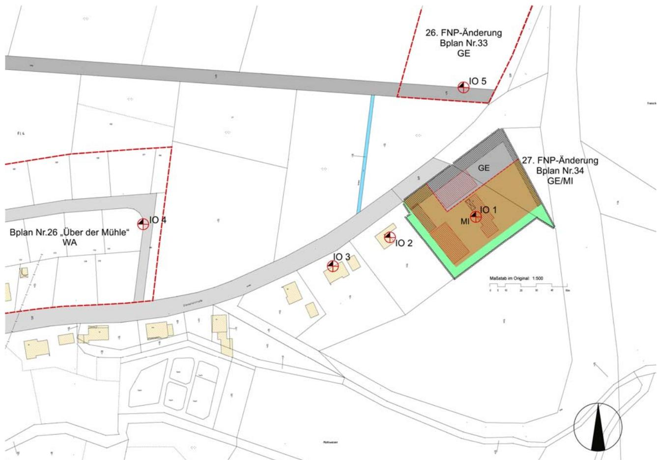
**Abb. 7.1:** Schalltechnischer Lageplan mit Eintragung der maßgeblichen Immissionsorte
